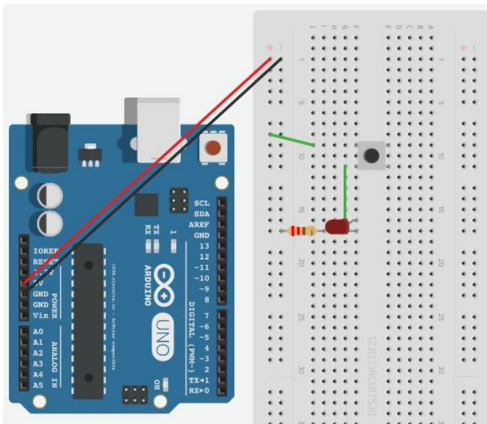
Note : On utilise ici le courant (une différence de potentiel de 5V) fourni par le port USB (on doit donc connecter le fil USB de l'ordinateur à la carte Arduino) de l'ordinateur pour alimenter notre circuit.
