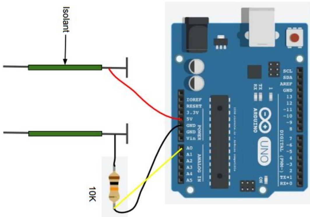
À noter que nous utilisons ici 2 clous (galvaniser de préférence pour éviter une oxydation trop rapide), séparer d'environ 2 cm par un matériau isolant, sur lesquels nous avons ajouter un isolant afin d'aller prendre la mesure à une certaine profondeur dans la terre (l'humidité du sol varie en fonction de la profondeur). Voici une photo de notre sonde (au lieu du ruban, utiliser du silicone comme isolant pour une sonde plus durable) :
